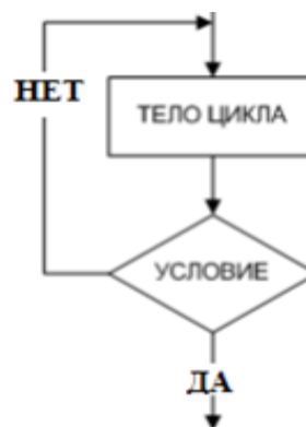
Рис. 1.7. Алгоритм циклической структуры с постусловием
