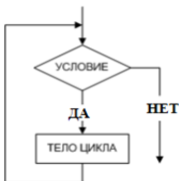
Рис. 1.6. Алгоритм циклической структуры с предусловием
